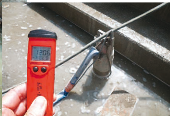
L'eau sur la paroi béton affichant pH 12.06 48 h après bétonnage.
