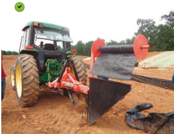
Dispositif d'installation automatique des barrières de rétention.
