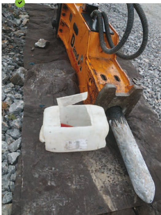
Équipement posé sur géotextile absorbant.
