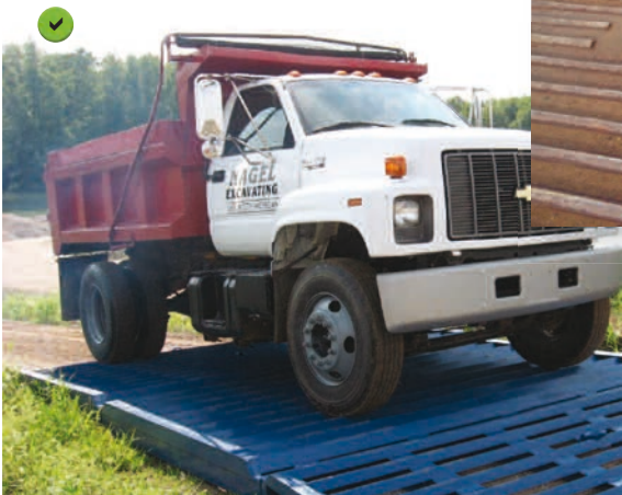
La longueur de la grille correspond à environ 10 fois le diamètre ou 3,5 fois la circonférence des roues. La forme ondulée écarte la gomme des pneus, ce qui fait tomber la boue et les cailloux incrustés.
