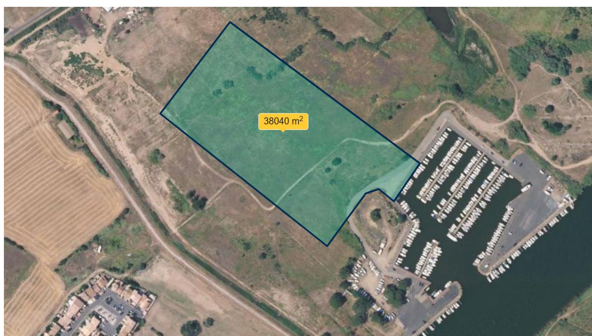
Figure 28 : Emprise potentielle de l'extension du bassin portuaire de Sérignan par creusement de parcelles acquises sur le milieu terrestre
